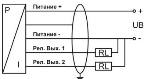
Рисунок В.4. Двухпроводная схема включения (токовый сигнал) с двумя релейными выходами (тип PNP)
