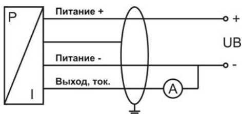
Рисунок В.3. Двухпроводная схема включения (токовый сигнал)
