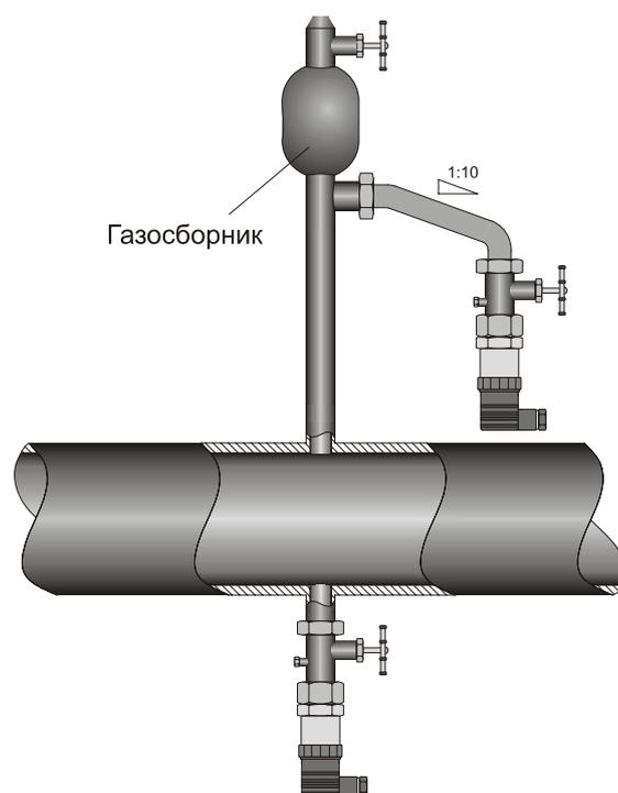
**Рисунок 2.** Монтаж датчика для измерения давления жидкости.
