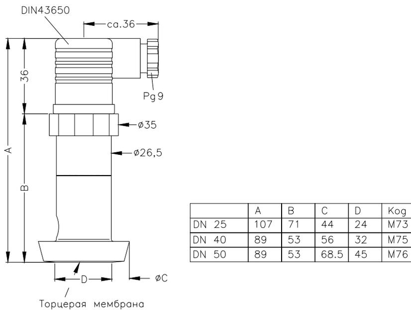
Фланцевые механические соединения.
