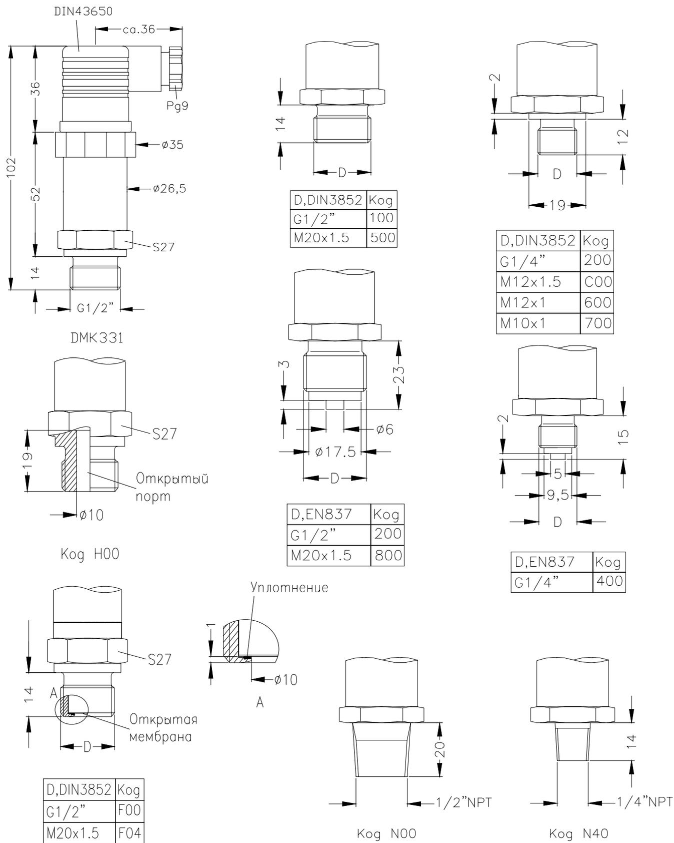
Длина датчика DMK 331 в искробезопасном исполнении больше на 10 мм.
