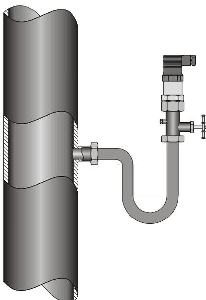
При измерении давления пара, для снижения температуры, воздействующей на мембрану, рекомендуется использовать импульсные трубки. Предварительно импульсная трубка должна быть заполнена водой.
