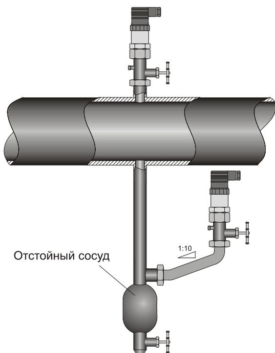
**Рисунок 1.** Монтаж датчика для измерения давления газа.
