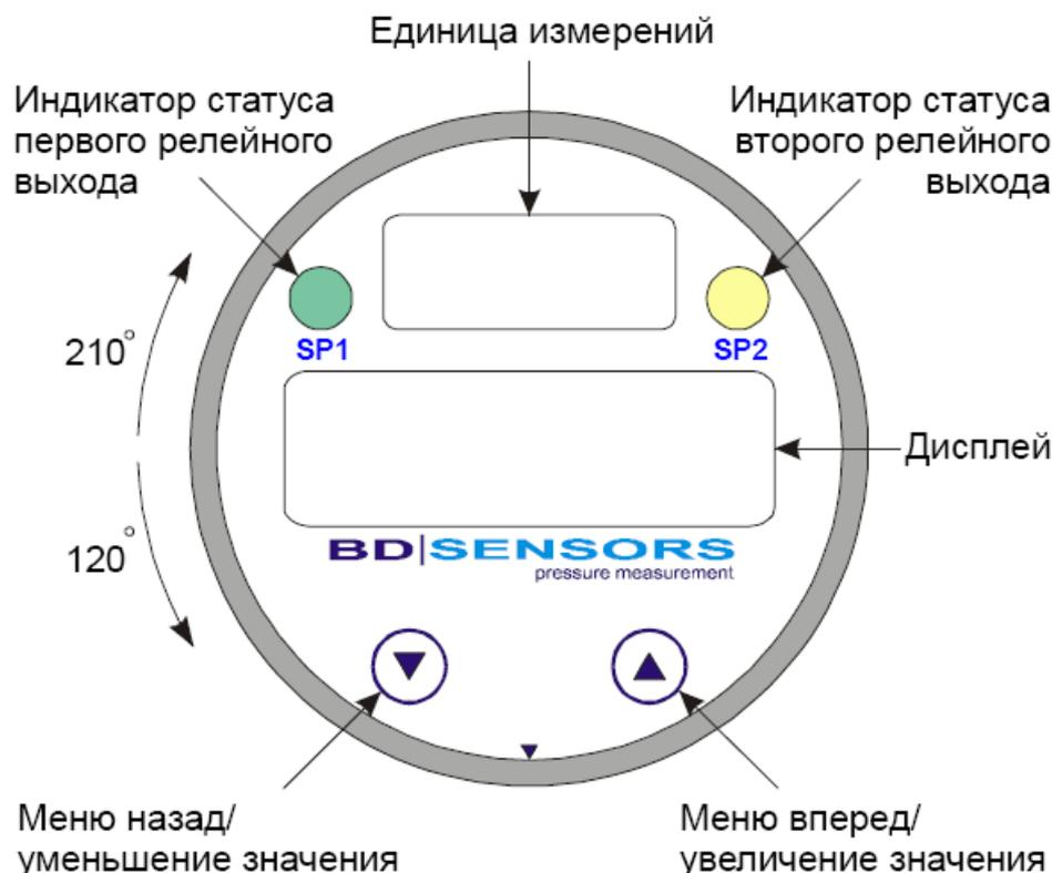
**Рисунок 5.** Органы отображения и настройки датчика
