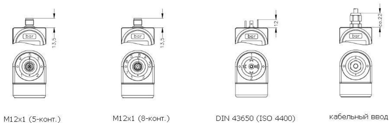
**Рисунок Б.3.** Типы электрических присоединений.
