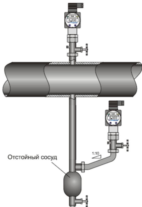
**Рисунок 1.** Варианты монтажа датчика для измерения давления газа.
