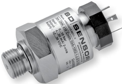
Преобразователь давления DMK 458 разработан специально для морских применений. Кроме штуцерного исполнения, возможно исполнение с различными торцевыми мембранами, позволяющими использовать датчик в густых, вязких и загрязнённых средах.
