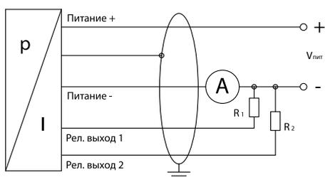
3-х пров. (вых. сигнал - напряжение/ток)
