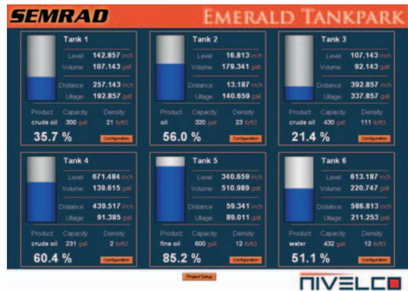
Измерение уровней в парке емкостей: Измерение уровня в емкостях для нефти и воды уровнемером **MicroTREK** и **MULTICONT**, в нескольких местах связь через интернет.
