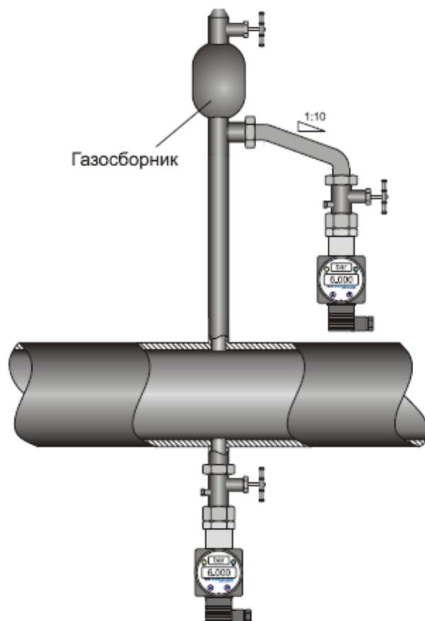
**Рисунок 2.** Варианты монтажа датчика для измерения давления жидкости.
