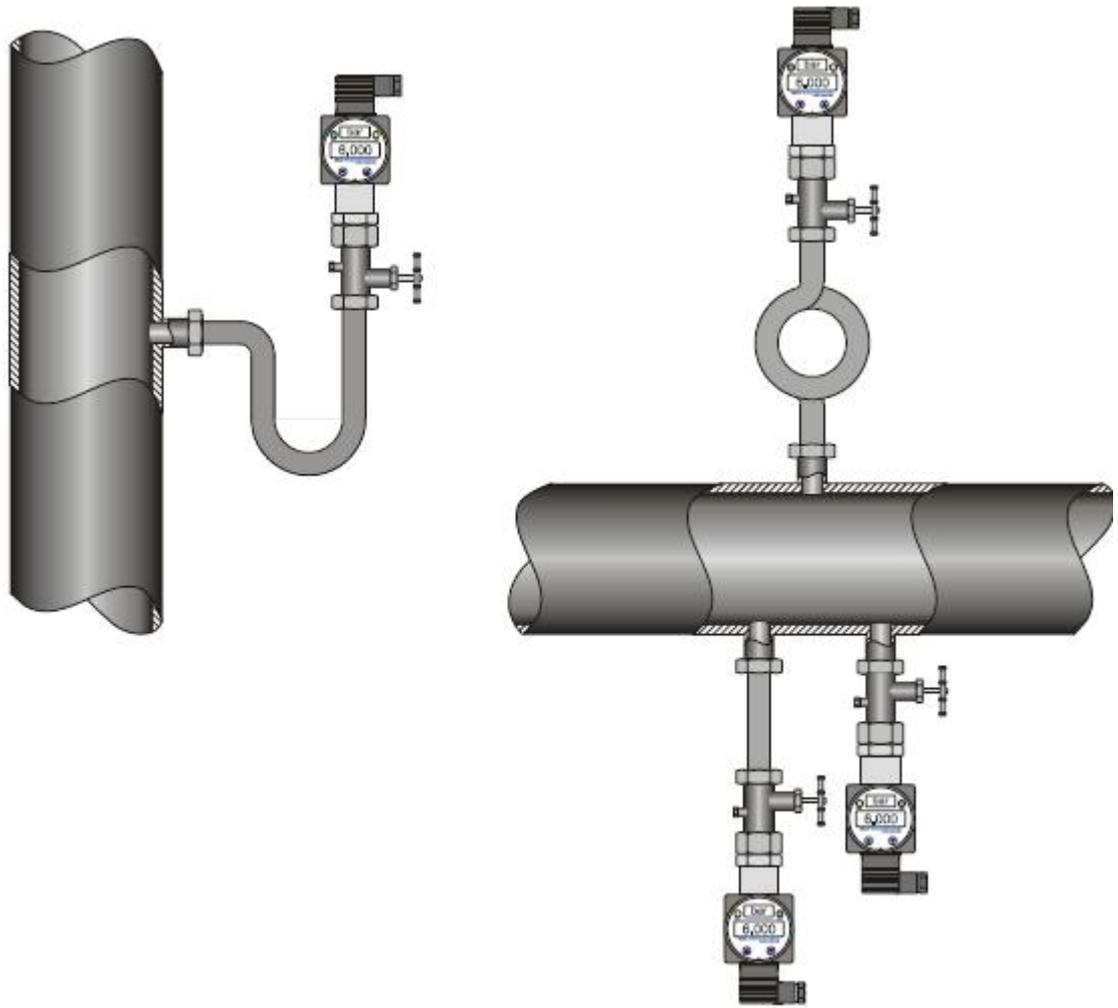
**Рисунок 3.** Варианты монтажа датчика для измерения давления пара.
