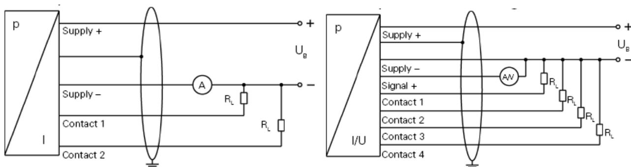
**Рисунок В.1** – Схемы внешних электрических соединений датчика обычного исполнения.
