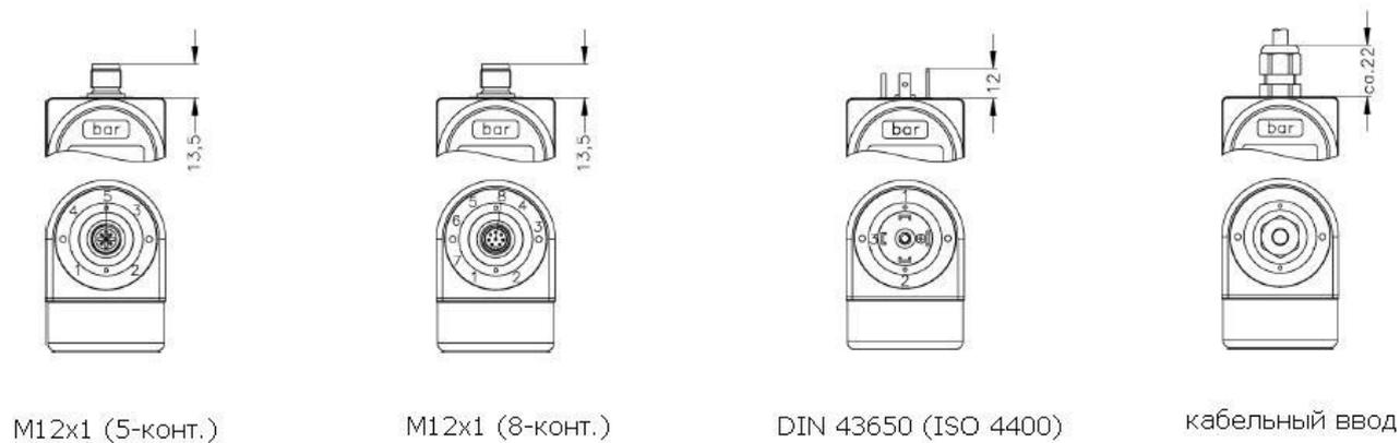
**Рисунок Б.3.** Типы электрических присоединений.
